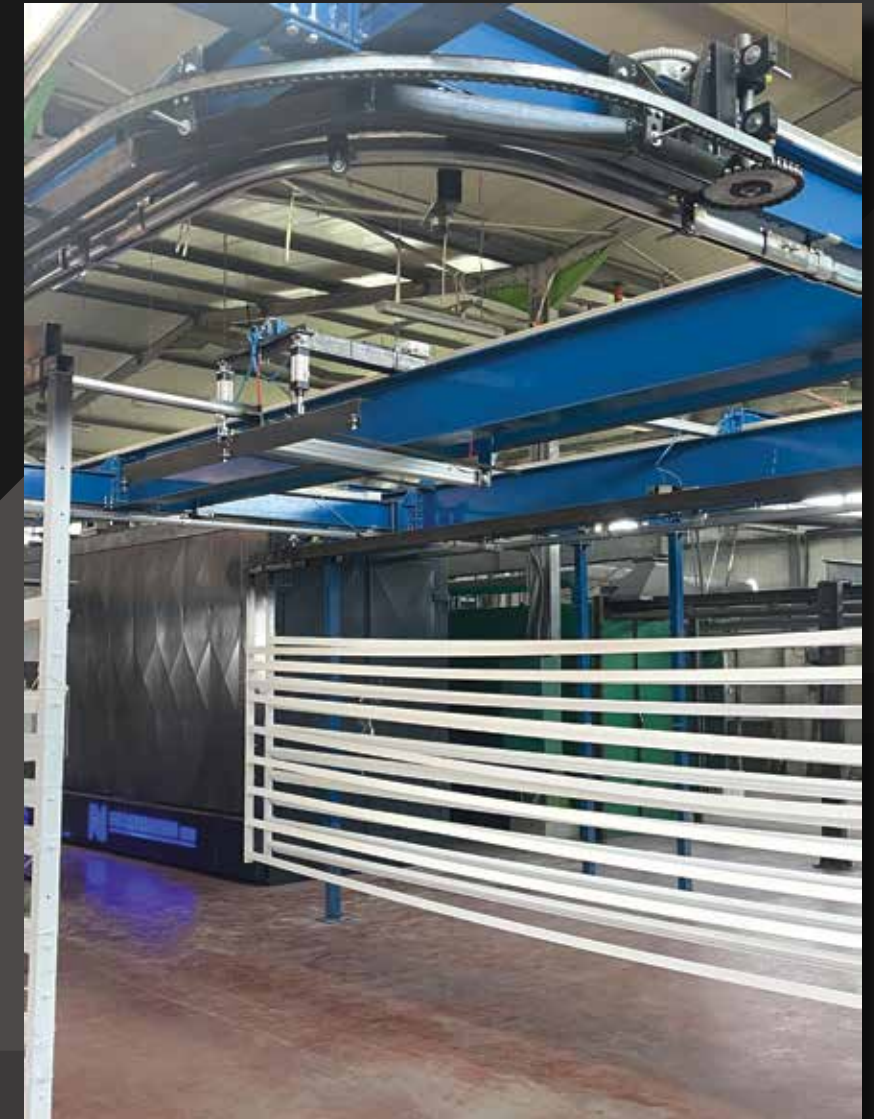
Σύστημα για την αυτόματη προώθηση των κρεμαστών στα parking μέσω παλμογεννήτριας και φωτοκυττάρων.
